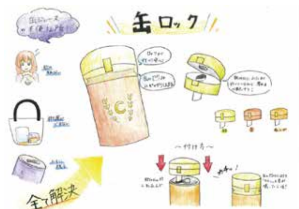
飲みかけの缶ジュースを持ち運び可能にする着脱式飲み口
