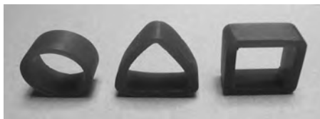
カービングワックスで丸、三角、四角のリングを制作
