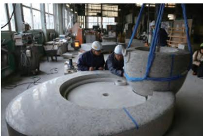
写真25 三次元曲線の石の組み合わせを確認する。
