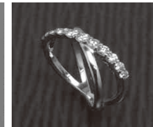
6.鋳造後、仕上げ、石留めしてリングの完成。CAD+ロスト・ワックス・キャストリング法で量産する
