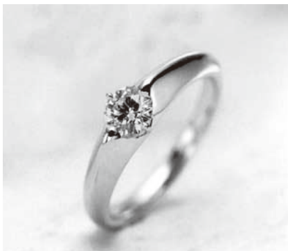
57.(株)伊東商店エンゲージメントリング プロダクトデザイン(量産)の代表的な商品。 デザイン画→原型制作(3DCAD)→ゴム型作り→ ワックスパターンツリーの製作→埋没→ 鋳造→仕上げ→石留め→完成。とロスト・ワッ クス・キャストリング法を使用する。
