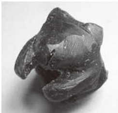
2.ハードワックスをプロペラヤスリで大まかに形を削り出す
