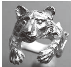
5.ワックス原型をシルバーに鑄造して、ヤスリ、タガネで補正をする
