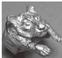
7.模様部分をプラチナで鑄造して、K18本体に、プラチナの模様部分をろう付けする
