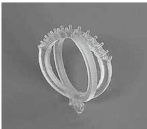
5.三次元で起こしたデータを紫外線レーザーで硬化させた樹脂の立体モデルが出来た。これをゴム型作成。鋳造する
