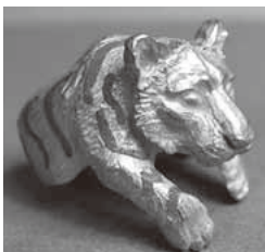
6.シルバー原型をゴム型で作成し、ワックス取り、埋没、K18で鑄造後、模様部分をワックスで型取り
