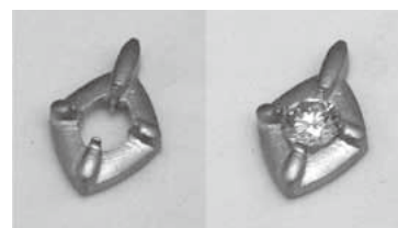
8.ワックス原型が出来たら鑄造して、仕上げ、石留め、完成
