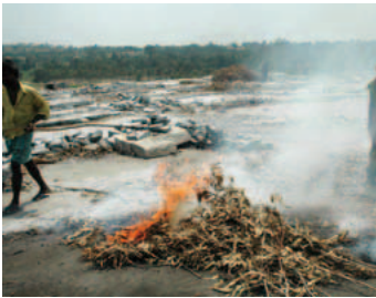
左/写真28 インドにおける花崗岩の採石風景。中/写真29 炎の熱により意図した厚さで石がはがれる。右/写真30 舗装された状態。東海市の海の波を表すためにこの石材を選択。
